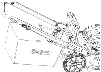
4. Чтобы снять травосборник, поднимите заднюю дверцу выброса газонокосилки.
